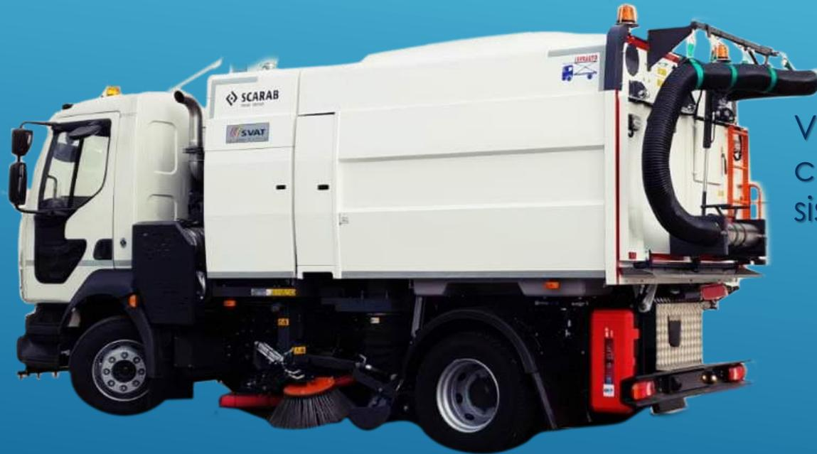
Vehículo destinado a la limpieza de las calles mediante escobillas rotatorias y sistema frontal de rociado de agua.
