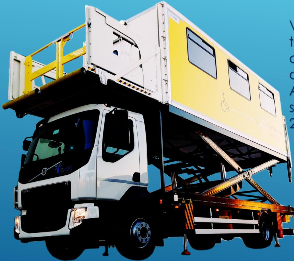
Vehículo diseñado y construido para el transporte de pasajeros con otras capacidades o movilidad reducida en aeropuertos para aviones Airbus A319, A320, A330/340, etc. y Boeing B-787 y similares; con medidas comprendidas entre 2750/2900mm hasta 6000mm.
