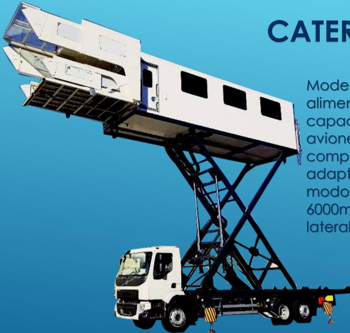
Modelos diseñados para abastecimiento de alimentos / transporte de pasajeros con otras capacidades o movilidad reducida a aviones Airbus A380, con alturas comprendidas entre 2.900mm y 8.200mm. y adaptable a otras aeronaves inferiores en modo aeronave convencional, limitado a 6000mm de altura sin desplazamiento lateral.
