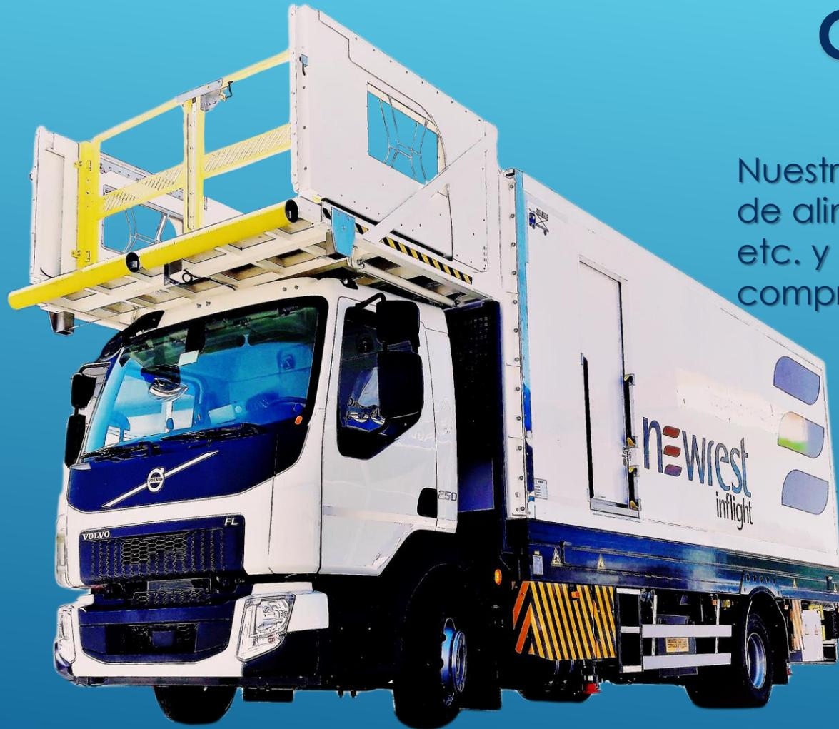
Nuestro modelo JOFR-01 se adapta para abastecer de alimentos a aviones Airbus A319, A320, A330/340, etc. y Boeing B-787 y similares; con medidas comprendidas entre 2750/2900mm hasta 6000mm.
