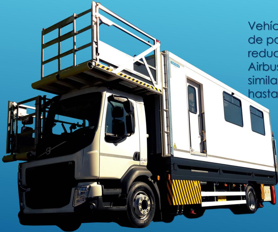
Vehículo diseñado y construido para el transporte de pasajeros con otras capacidades o movilidad reducida en aeropuertos para abastecer aviones Airbus A319, A320, A330/340, etc. y Boeing B-787 y similares; con medidas comprendidas entre 1350mm hasta 6000mm.
