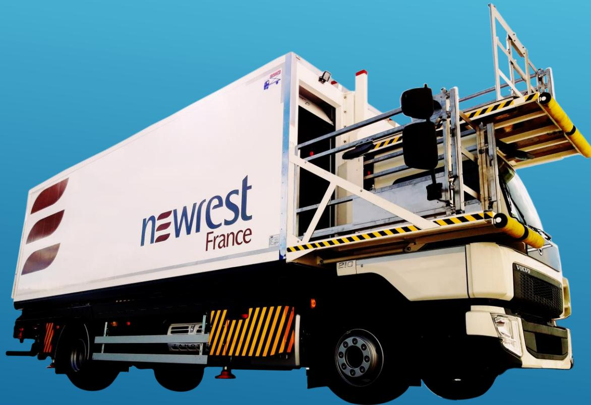
Nuestro modelo JOFR-03 L se adapta para abastecer de alimentos a aviones Airbus A319, A320, A330/340, etc. y Boeing B-787 y similares; con medidas comprendidas entre 1350mm hasta 6000mm.
